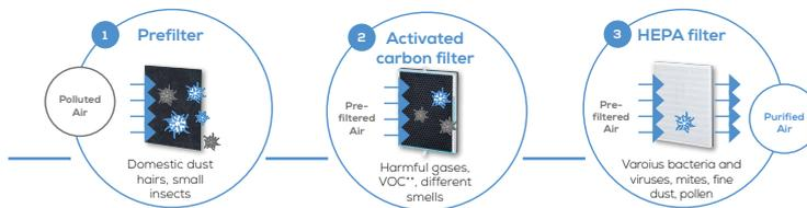
Funktionsweise des Luftreinigers: Hausstaub, Tierhaare, Gerüche, Pollen, schädliche Gase sowie diverse Bakterien und Viren werden mit Hilfe eines dreischichtigen Filtersystems aus der Luft gefiltert.
