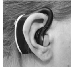
Kulaklıktan kulağınızın içinde kolayca kayıyorsa, en uygun şekil için cihazla birlikte verilen diğer kulaklıkları deneyin.
