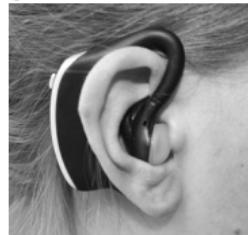
Wenn der Ohrstöpsel in Ihrem Ohr leicht verrutscht, probieren Sie die anderen im Lieferumfang enthaltenen Ohrstöpsel aus, für eine optimale Passform. Für eine individuelle Anpassung gibt es die Möglichkeit, den kleinen Haken am Gerät vorsichtig mit einer Schere zu kürzen.
