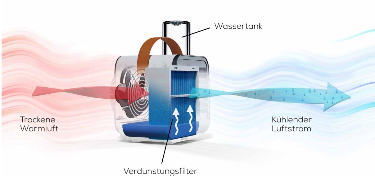
Der Luftventilator saugt die trockene Warmluft des Raumes an, welche auf den mit Wasser vollgesaugten Verdunstungsfilter trifft. Durch den Kontakt zwischen Luftstrom und feuchter Filteroberfläche verdunstet das Wasser. Die Raumluft nimmt die Feuchtigkeit auf. Dabei wird der Raumluft die Wärmeenergie entzogen, die für die Verdunstung notwendig ist. Die fühlbare Temperatur der Raumluft sinkt.
